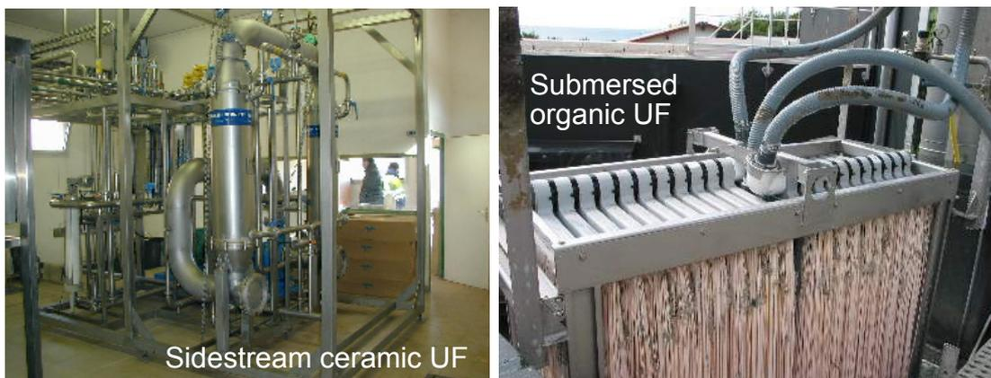
**Рисунок 1.** Внешний вид исследованных МБР-систем (керамическая и погружная органическая), используемых для очистки производственных и городских сточных вод соответственно
